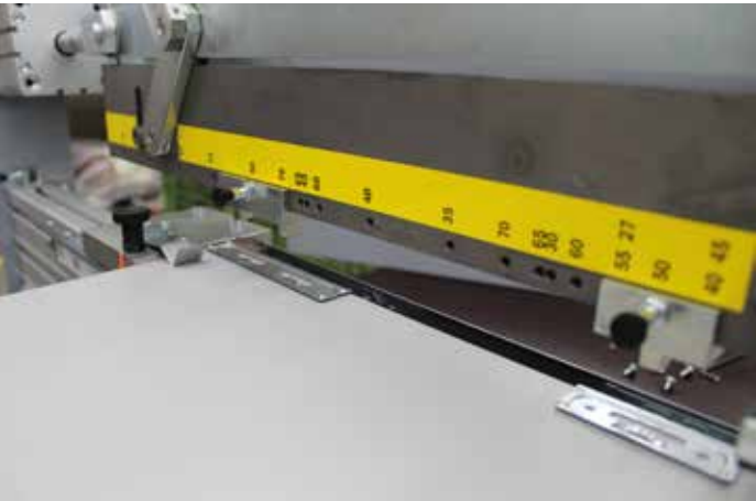
Fig. 10 : réglage du patin de serrage
