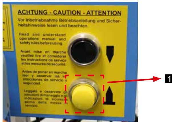
Фиг. 27: Жълт бутон: освобождаване на притискащите устройства
