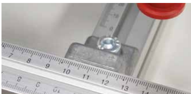
Фиг. 31: Упорен линеал с винт с глава с вътрешен шестостен
