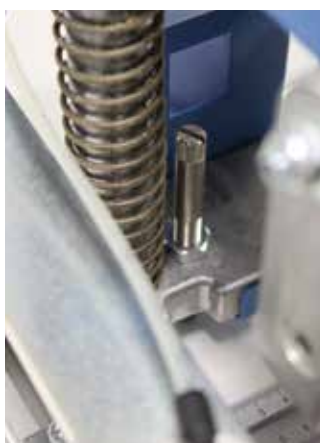
Фиг. 30: Ограничител за дълбочината на пробиване
