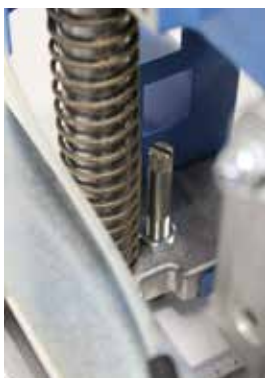
Фиг. 22: Настройване на дълбочината на пробиване
