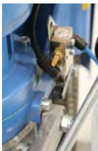
Фиг. 20: Монтаж на „Подвижна скоба с опипваща ролка“
