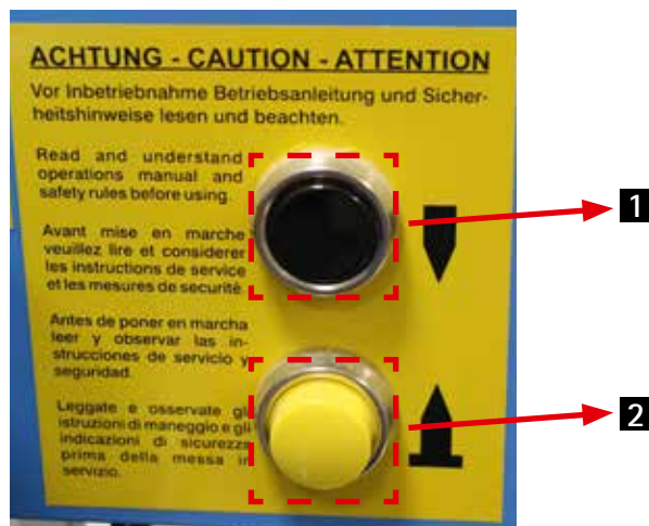
Obr. 37: Tlačítko spínací a pro uvolnění patek
