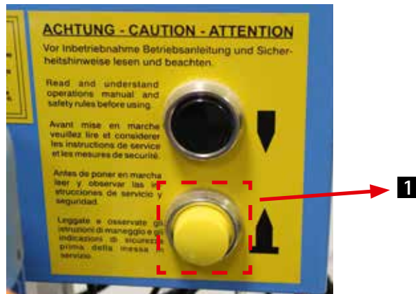
Obr. 27: Žluté tlačítko: Uvolnění přitlačných patek
