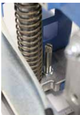
Obr. 22: Nastavení hloubky vrtání
