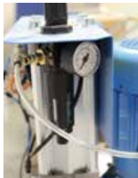
Obr. 4: Jednotka úpravy stlačeného vzduchu
