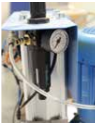
Fig. 4: Unidad de mantenimiento del sistema neumático
