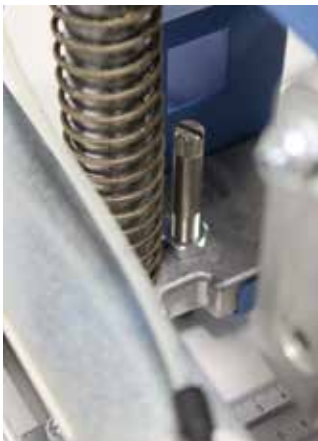
Afb. 30: boordiepte-aanslag met zeskantschroef
