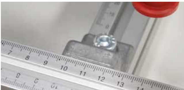
Afb. 31: aanslagliniaal met inbuschroef
