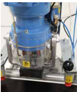
Rys. 36: Matryca do wciskania zawiasów
