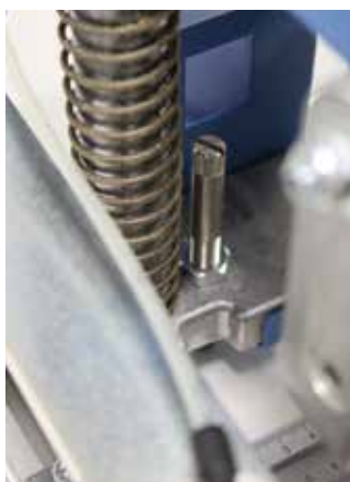
Рис. 30: Упор для глубины сверления с винтом с шестигранной головкой
