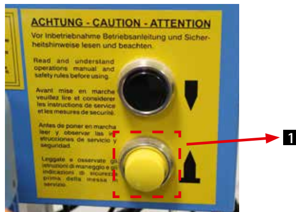
Рис. 27: Желтая кнопка: отсоединение прижимов
