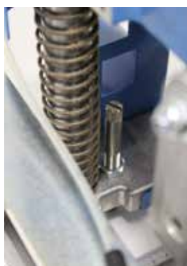
Рис. 22: Настройка глубины сверления
