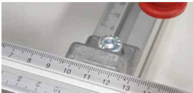
Рис. 31: Упорная линейка с винтом с внутренним шестигранником
