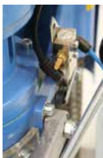
Рис. 20: Поворотная скоба с контактным роликом
