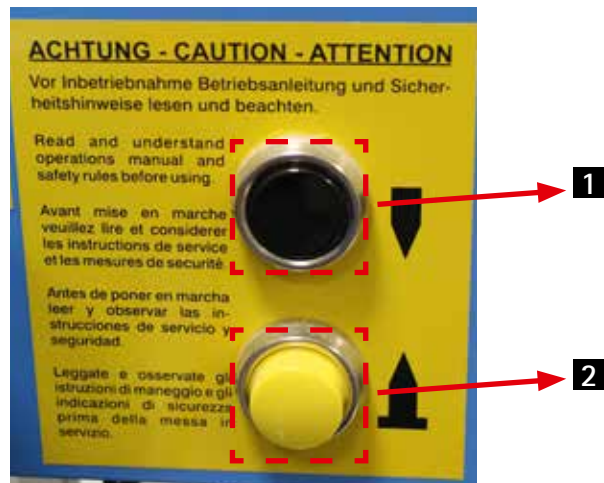
Рис. 37: Ручное управление и контактный выключатель
