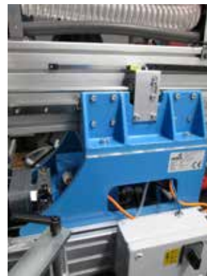
Obr.: Hlavní vypínač (z pohledu obsluhy na pravé straně podstavce stroje)
