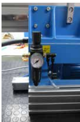
Obr.: Jednotka pro úpravu stlačeného vzduchu (z pohledu obsluhy na levé straně podstavce stroje)
