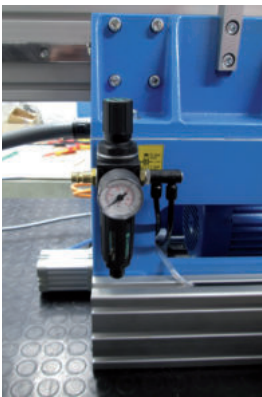
Abb. 5: Wartungseinheit Pneumatik (aus Bedienerseite seitlich links hinten am Maschinengestell)
