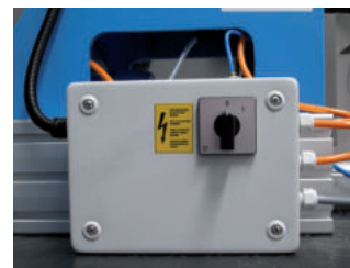
Abb. 3: Hauptschalter (aus Bediener Sicht seitlich rechts am Maschinengestell)
