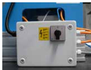
SI.: Glavna sklopka (gledano od rukovatelja s desne strane postolja stroja)
