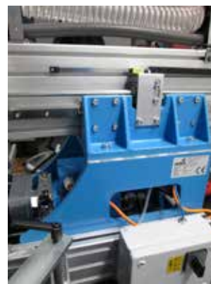
SI.: Glavna sklopka (gledano od rukovatelja s desne strane postolja stroja)
