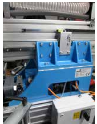
Kuva: Pääkytkin (käyttäjän näkökulmasta sivussa oikealla koneen rungossa)
