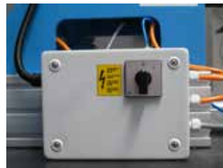
Kuva: Pääkytkin (käyttäjän näkökulmasta sivussa oikealla koneen rungossa)
