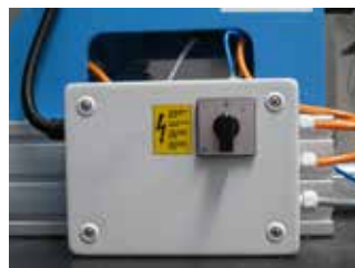
Pav.: pagrindinis jungiklis (žiūrint iš operatoriaus darbo vietos – dešiniajame įrenginio stovo šone)
