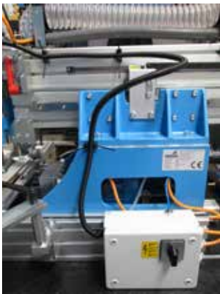
Pav.: valdymo elementai ant gręžimo ir įspaudimo įrenginio
