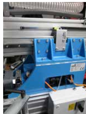
Pav.: pagrindinis jungiklis (žiūrint iš operatoriaus darbo vietos – dešiniajame įrenginio stovo šone)
