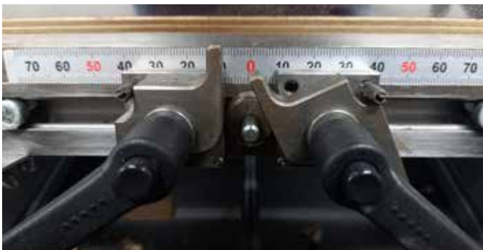
Fig.: Setarea opritorului central
