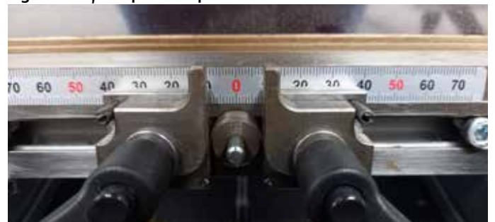
Fig.: Setarea opritorului central
