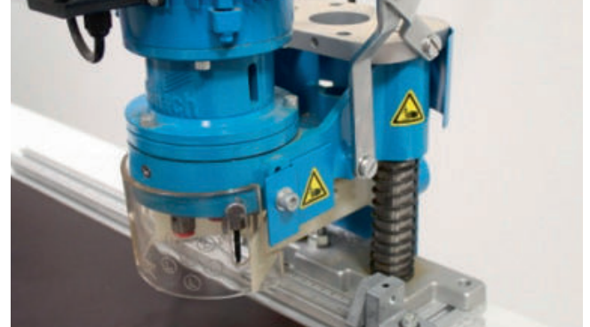
Abb. 4: Verschiebbare Schutzscheibe an Bohrspindeln
