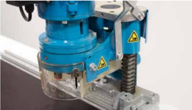
Fig. 4: Disco de protección ajustable en los husillos
