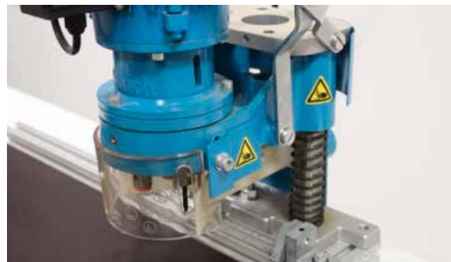
Fig. 4 : vitre de protection mobile pour les broches de perçage
