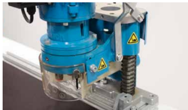
Fig. 4: rondella di protezione mobile per i mandrini di foratura
