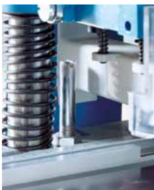
Fig. 14: regolazione della profondità di foratura
