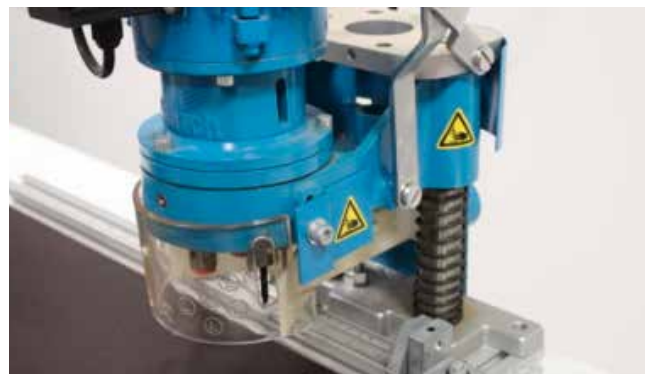
Afb. 4: verschuifbare beschermplaat bij boorassen
