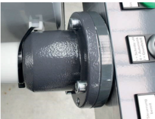
Abb. 18: Transportsicherung am Bedientableau
